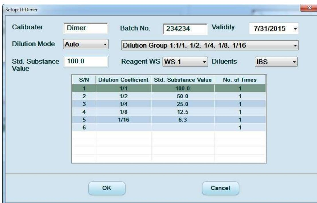
Fig. 10-3: Configuração do modo de calibração automática
