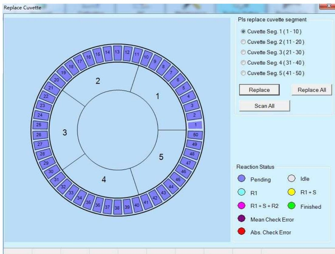
Esta tela permite substituir o segmento da cubeta da reação na bandeja de reação.
