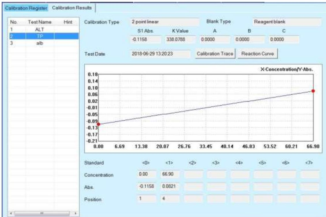
Essa tela permite visualizar os resultados da calibração, a curva de reação de cada solução padrão/calibrador e a curva de calibração.
