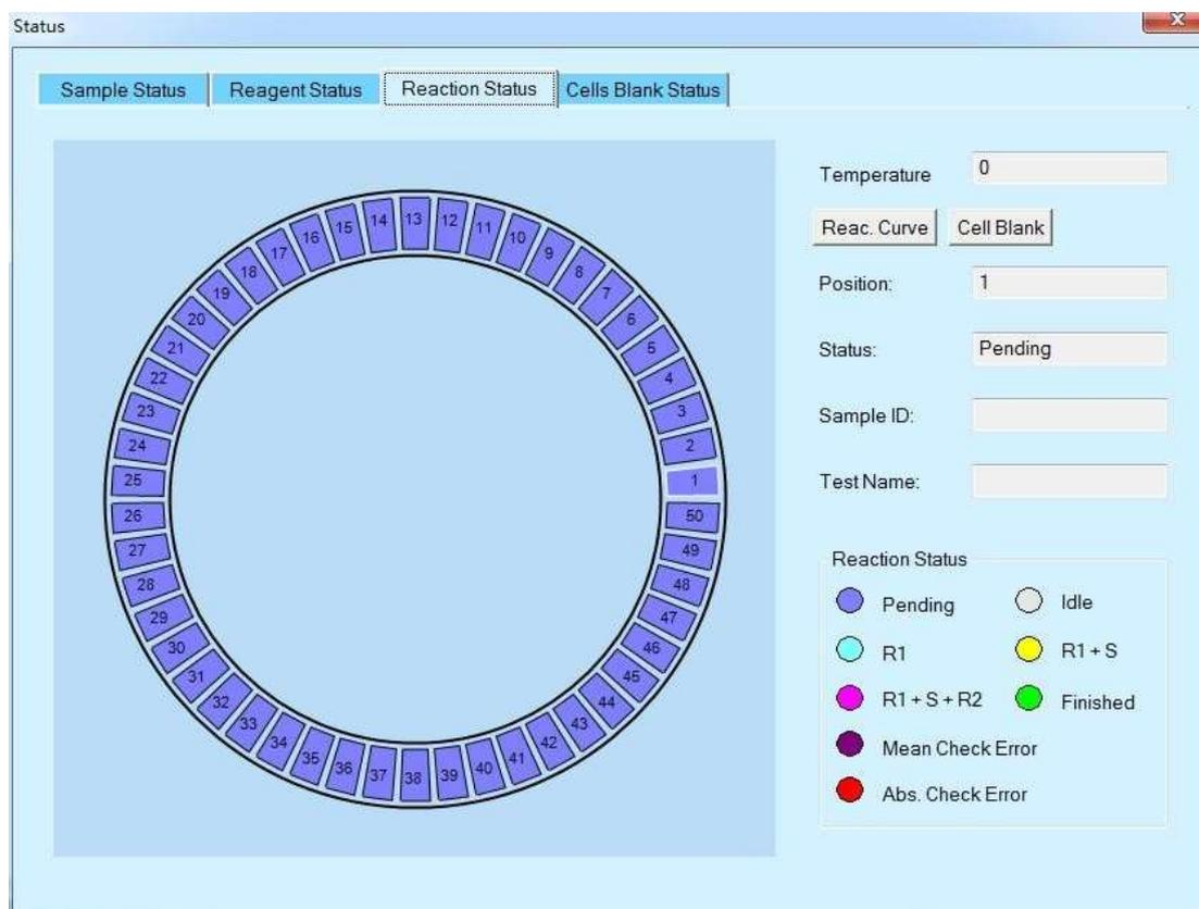
Essa janela permite visualizar o status da bandeja de reação a qualquer momento. Clique em uma posição para exibir suas informações à direita.
