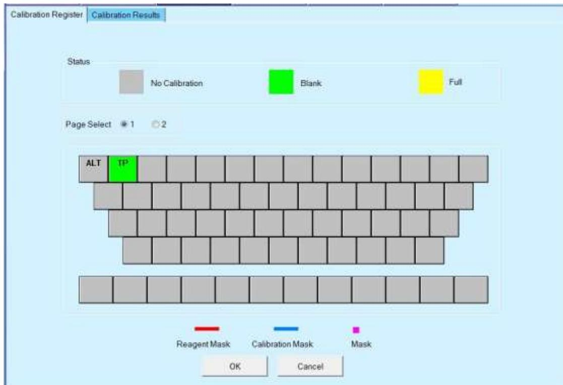
Essa janela permite registrar a calibração somente do branco do reagente ou a calibração completa (branco de reagente e todos os padrões/calibradores).
