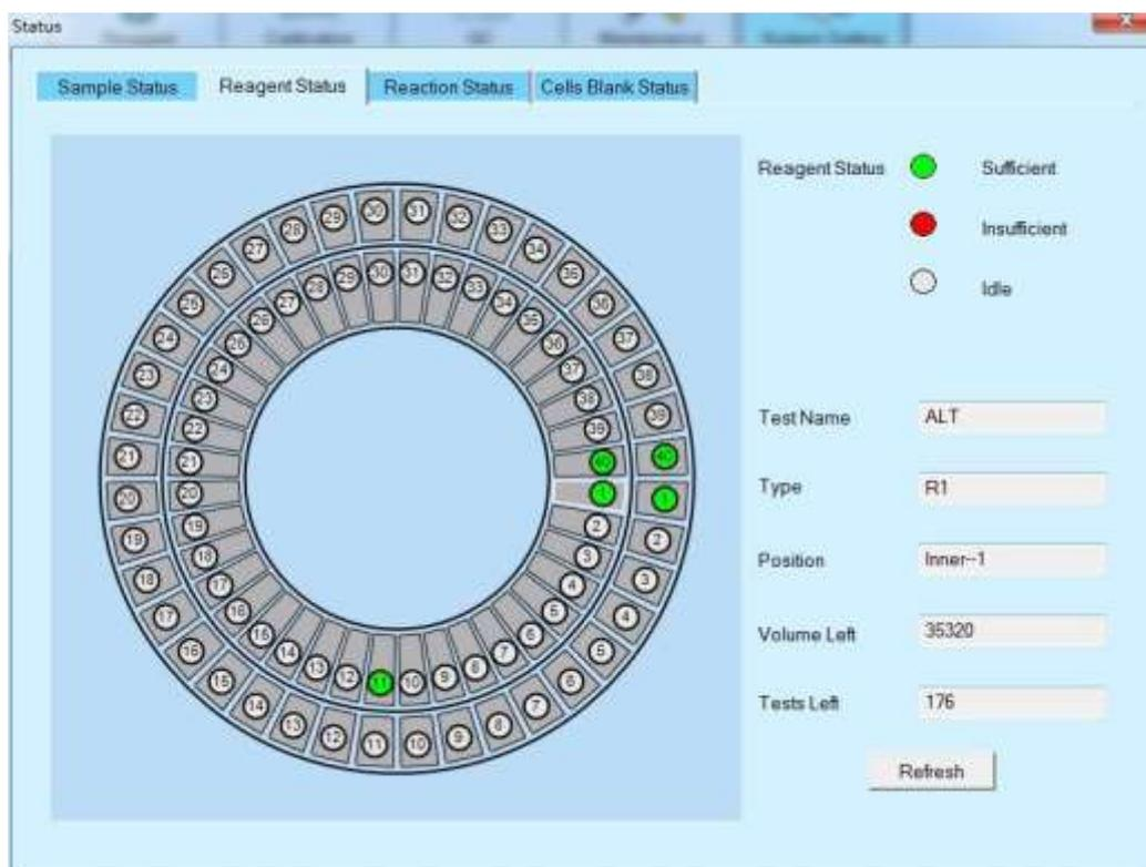
Essa janela permite visualizar o status da bandeja de reagentes a qualquer momento. Clique em uma posição para exibir suas informações à direita.
